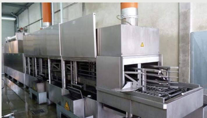
Die KLT-Waschanlage reinigt je nach Verschmutzungsgrad bis zu 1.000 Boxen – pro Stunde!
