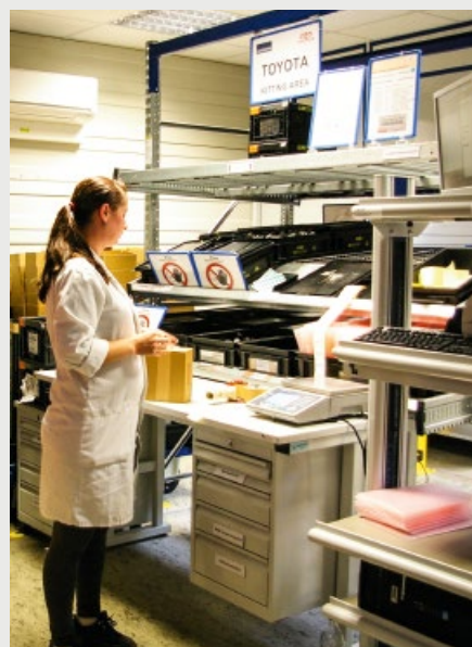
Die „Kitting Area“ ist ein ESD-Arbeitsplatz.
